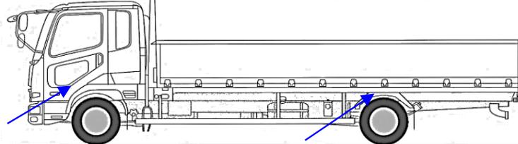
タイヤハウスの上 横ネタ2本腐食→補強(左右で4本)
