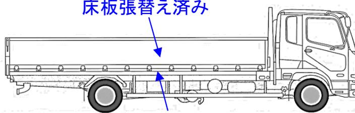
台枠サビ浮き有→錆取後塗装※凸凹有
